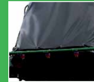
Wasserpumpe und Sprühsystem zur Staubreduzierung
